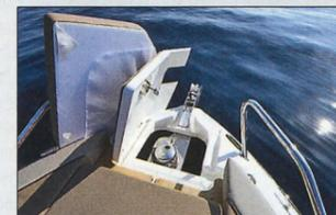
Sur les deux bateaux, le balcon s'interrompt au niveau de la proue équipée d'une baille et d'un davier. Le guindeau est optionnel sur le Parker comme sur le Quicksilver.
