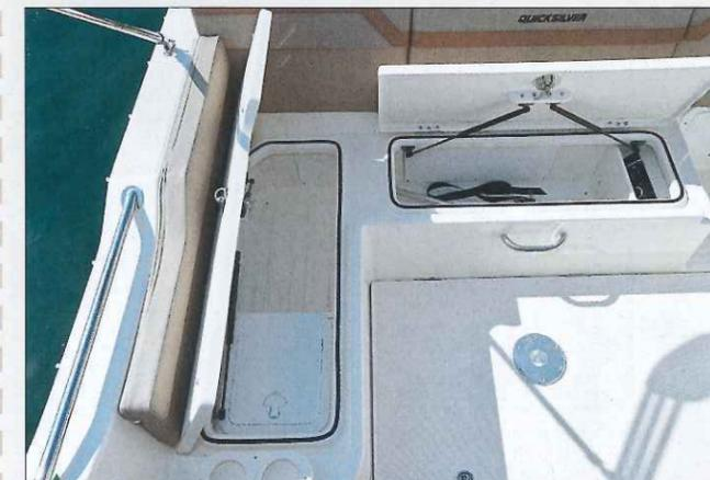
Deux vérins soutiennent les capots de coffre pour en faciliter l'ouverture, des détails qui en disent long sur le niveau de finition.
